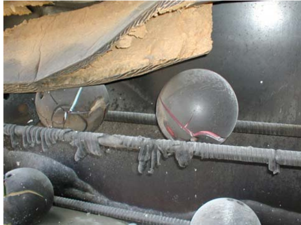
Abb. 6: Durch die Hitze geplatze Bowling-Kugeln [1]
